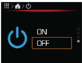
Durch das mehrmalige Drücken auf die Taste **^** oder **v** wählen Sie den Wert OFF (aus) oder ON (ein). Bestätigen Sie die Einstellung mit dem Drücken auf die Taste **OK**.
