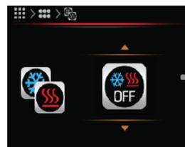
Durch das mehrmalige Drücken auf die Taste **^** oder **v** wählen Sie den Wert für den Heizbetrieb und die Erwärmung des Brauchwassers.
