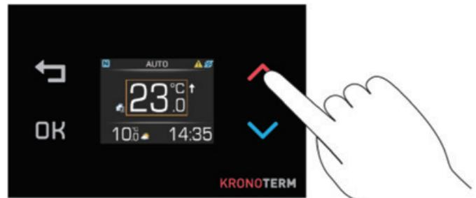
Drücken Sie die Taste oder für die Anzeige der eingestellten Raumtemperatur. Die Temperatur wird durch einen orangefarbenen Rand gekennzeichnet.
