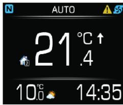
Das Parametermenü öffnen Sie mit dem Drücken auf die Taste **OK**. Durch das mehrmalige Drücken auf die Taste **↑** oder **↓** suchen Sie nach dem Parameter Betriebsart des Heizkreises.
