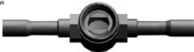
Bei einer grünen Schauglasanzeige befindet sich keine Feuchtigkeit im System. Bei gelber Anzeige befindet sich Feuchtigkeit im System. Setzen Sie sich in diesem Fall mit dem Vertragshändler in Verbindung.
