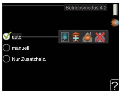
Der Betriebsmodus der Wärmepumpe wird normalerweise auf "auto" gestellt. Sie können die Wärmepumpe ebenfalls auf "Nur Zusatzheiz."
