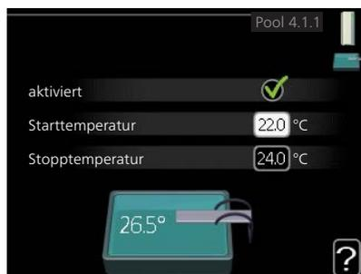
Hier legen Sie fest, ob die Poolsteuerung aktiviert sein soll und innerhalb welcher Temperaturgrenzen (Start- und Stopptemperatur) die Poolerwärmung stattfinden soll sowie wie viele Verdichter für diesen Pool gleichzeitig arbeiten dürfen.
