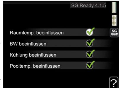
In der Stellung "Niedriger Preis" von "SG Ready" wird die Stopptemperatur für das Brauchwasser nur für den Verdichterbetrieb so hoch wie möglich eingestellt (Elektroheizpatrone nicht zulässig).
