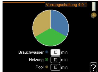
Hier legen Sie fest, wieviel Betriebszeit die Wärmepumpe für den jeweiligen Bedarf aufwenden soll, wenn mehr als ein Bedarf gleichzeitig vorliegt. Liegt nur ein Bedarf vor, wird dieser von der Wärmepumpe gedeckt.
