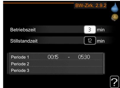
Hier können Sie die Brauchwasserzirkulation in bis zu drei Perioden pro Tag unterteilen. In den definierten Perioden arbeitet die Brauchwasser-Umwälzpumpe gemäß den Einstellungen oben.
