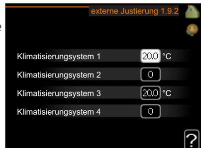
Durch Anbringen eines externen Schaltkontakts, z.B. Raumthermostat oder Schaltuhr, kann die Raumtemperatur vorübergehend oder periodisch erhöht oder verringert werden. Wenn der Schaltkontakt eingeschaltet ist, wird die Parallelverschiebung der Heizkurve um die im Menü gewählte Stufenanzahl geändert. Wenn ein Raumfühler installiert und aktiviert ist, wird die gewünschte Raumtemperatur (°C) eingestellt.
