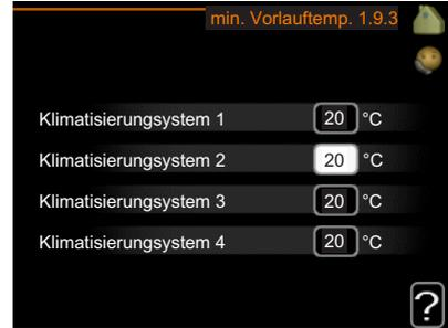
Hier stellen Sie die minimale Vorlauftemperatur des Klimatisierungssystem ein. Dementsprechend berechnet das F1145 niemals eine Temperatur, die unter dem eingestellten Wert liegt.
