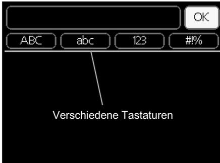
In einigen Menüs, die eine Texteingabe unterstützen, steht eine virtuelle Tastatur zur Verfügung.
