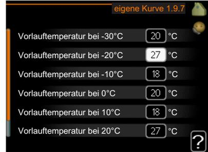
Hier können Sie bei speziellem Bedarf Ihre eigene Heizkurve definieren, indem Sie die gewünschten Vorlauftemperaturen bei unterschiedlichen Temperaturen vorgeben.
