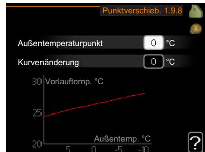
Hier können Sie eine Heizkurvenänderung bei einer bestimmten Außenlufttemperatur festlegen. Um die Raumtemperatur um ein Grad zu ändern, genügt normalerweise eine Stufe. In bestimmten Fällen können jedoch mehrere Stufen erforderlich sein.
