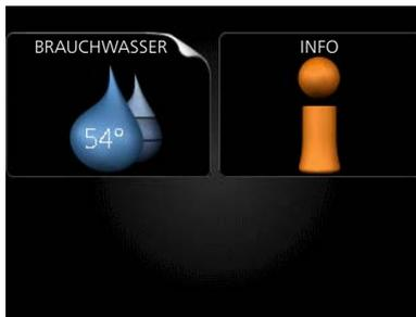
Wenn die Wärmepumpe als Slave eingestellt ist, wird ein begrenztes Hauptmenü im Display angezeigt, das den Hinweis enthält, dass die meisten Systemeinstellungen an der Master-Wärmepumpe vorzunehmen sind.
