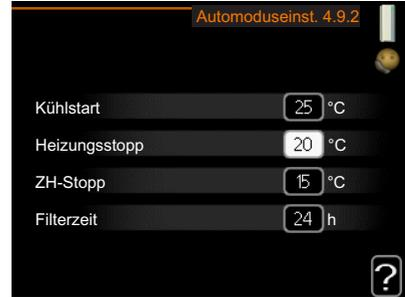
Wenn als Betriebsmodus "auto" eingestellt ist, bestimmt die Wärmepumpe ausgehend von der mittleren Außentemperatur selbst, wann Start und Stopp von Zusatzheizung sowie Brauchwasserbereitung zulässig sind. Wenn Kühlzubehör vorhanden ist oder die Wärmepumpe über eine integrierte Kühlfunktion verfügt, können Sie hier die Starttemperatur für die Kühlung festlegen.
