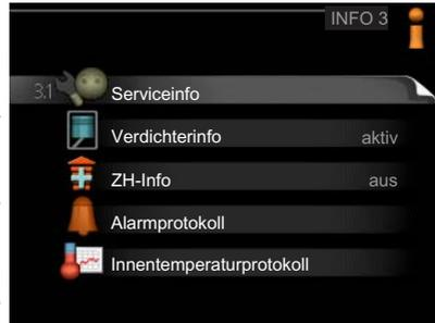
**Serviceinfo** zeigt die Temperaturwerte und Einstellungen der Anlage an.
